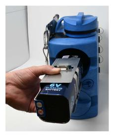
$Figure\ 2\text{-}15\ Installation\ of\ 6\ volt\ lantern\ batteries$
